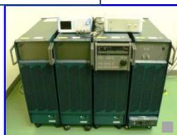
【ディップシミュレータ、電源環境シミュレータ】
